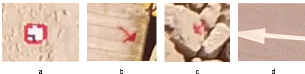
Figura 2.12 – Exemplos de pontos coordenados conforme ficam visíveis nas fotografias
