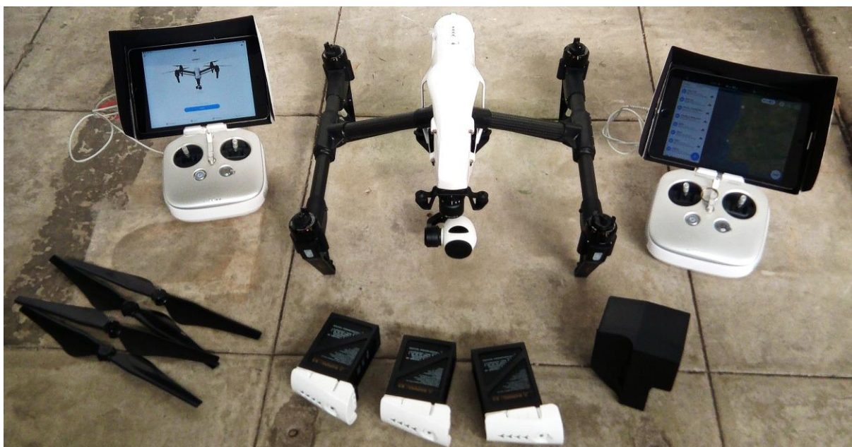
Figura 2.1 – Drone e acessórios utilizados nos levantamentos fotogramétricos
