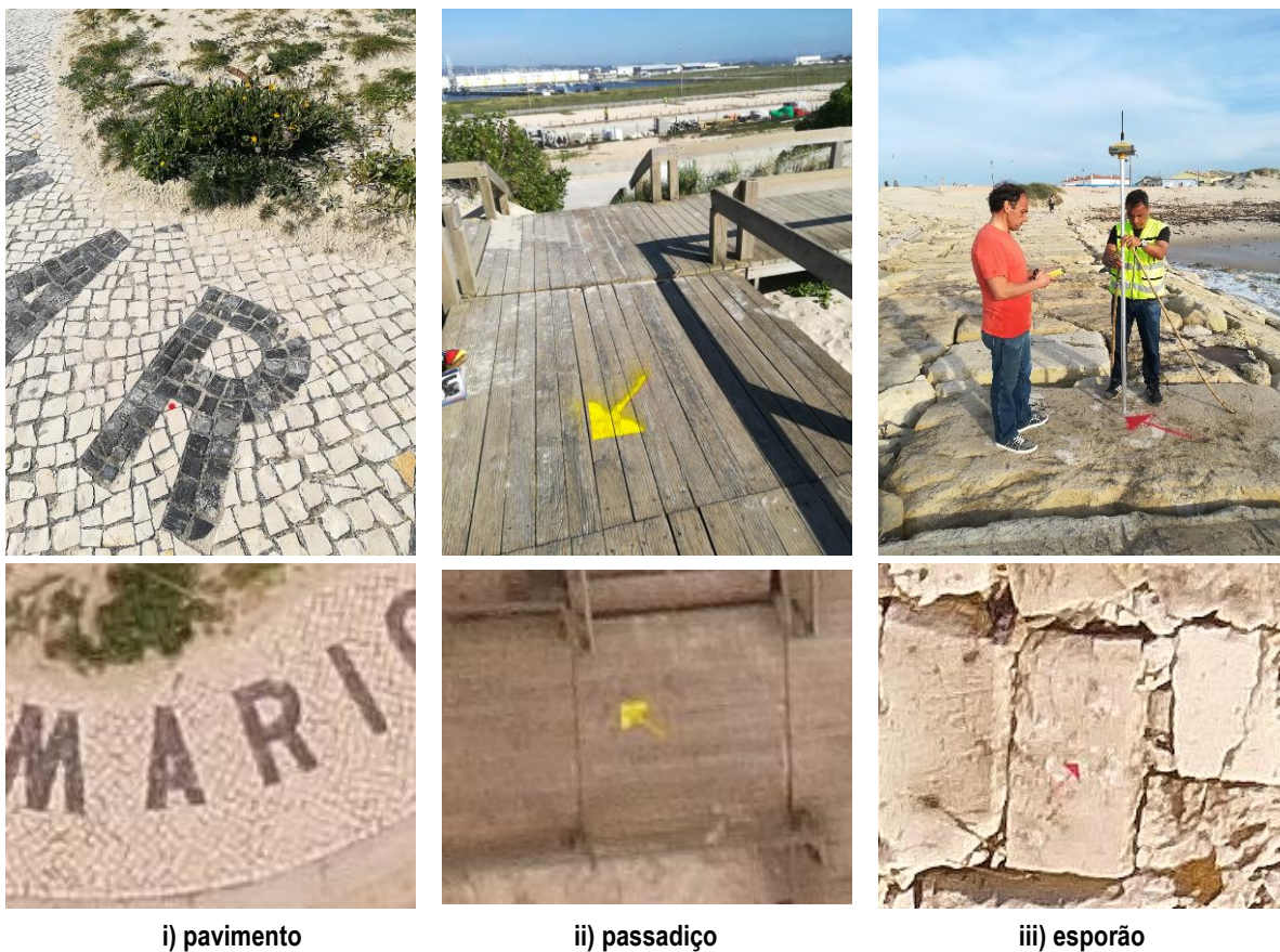
Figura 2.4 – Marcação de pontos de apoio para o levantamento (a última fotografia do alinhamento superior foi obtida durante a coordenação por GNSS)
