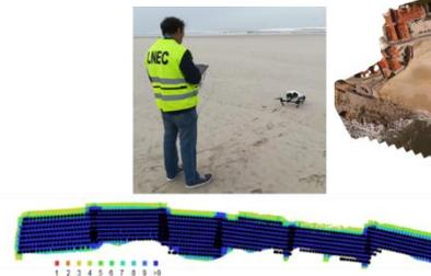
Levantamento fotogramétrico com *drone*
